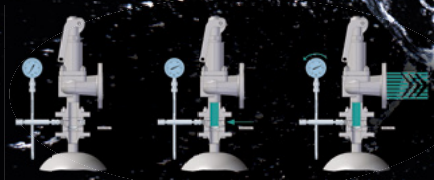
Abb. 4 In-situ-Test: Das Sicherheitsventil wird ohne vorherigen Ausbau geprüft. Durch eine hohe Rückdruckbelastbarkeit hält die eingebaute Berstscheibe diese Beanspruchung problemlos aus.
