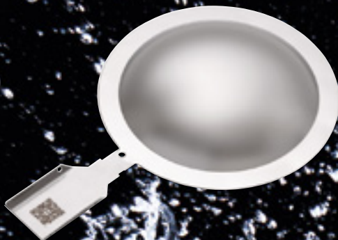
Abb. 2 Die glatte Wölbung der Berstscheibe ist dem Prozess zugewandt, verhindert Anbackungen und schützt das Berstelement.
