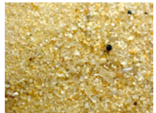
Abb. 1 Sandpartikel unterschiedlicher Größe, Form und chemischer Zusammensetzung.
