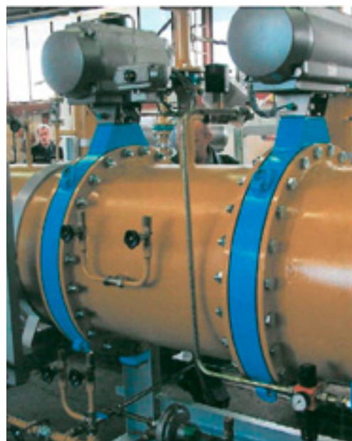
Zur Absperrung von brennbaren Gasen produziert die Herberholz GmbH Absperrklappen nach der DIN EN 161 A.
