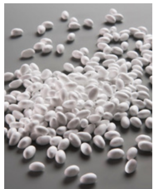
Material mit Rückpralleffekt: 2.500 der Infinergy-Schaumperlen bilden die Mittelsohle des neuen Laufschuhs.
