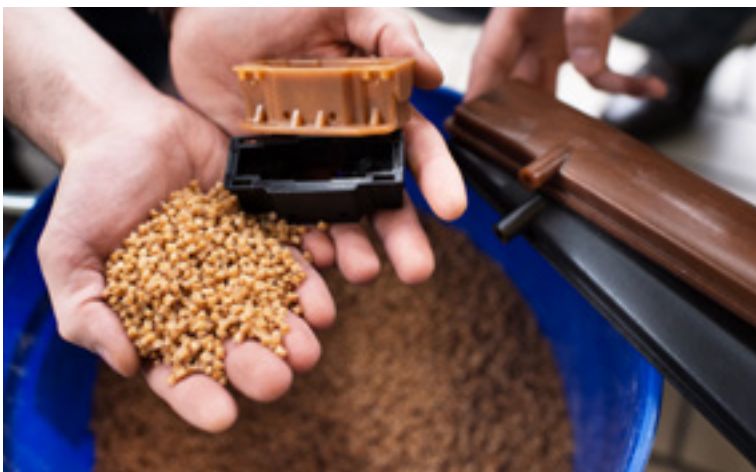
Granulat und spritzgegossene Bauteile aus biobasiertem Polyamid mit Cellulosegeneratfasern
