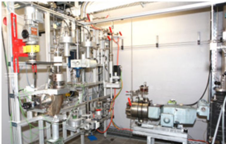
Abb. 1 Hochdruck-Polymerisations-Mini-Plant für Einsätze bis zu 300 °C und 3000 bar in den Hochdrucklaboren der TU Darmstadt.
