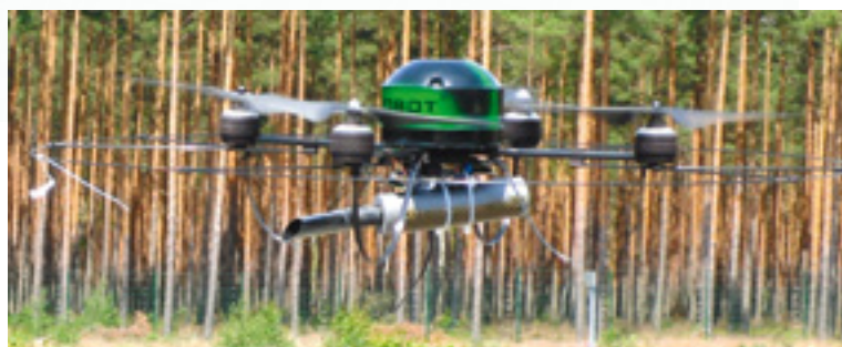
Abb. 1 Quadrokopter AR100-B mit integrierter Gasmesseinheit
