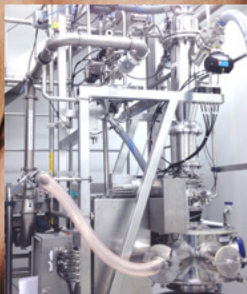
Abb.1 Trockenentleerung und Abfüllung in Fässer mittels aktiver Pulverförderung – Kombination aus PTS Powder Transfer System und DosiValve.
