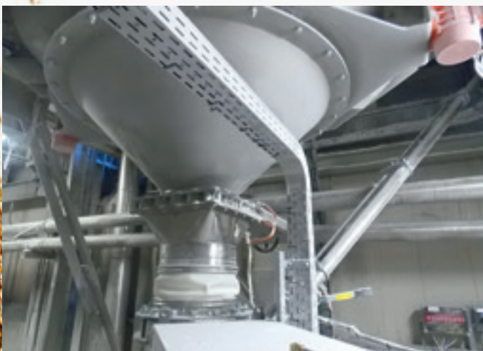
Abb.1 Neu bei WAM: „Low Profile“ VIB-Schieber als Absperrorgan unter einem Siloauslauf
