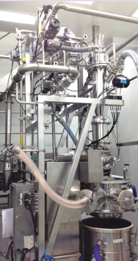
Abb. 1 Trocknerentleerung und Abfüllung in Fässer mittels aktiver Pulverförderung PTS/ DosiValve
