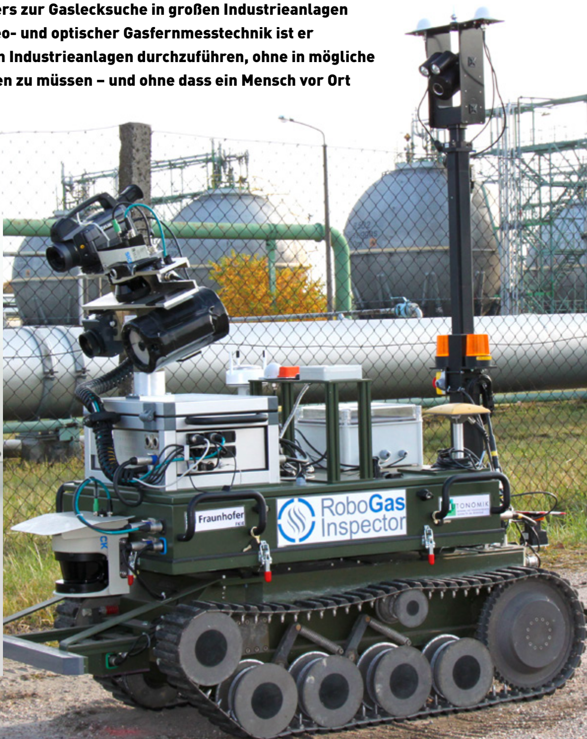
Abb. 1 Das Multisensor-Inspektionsmodul. Die Schwenk-Neige-Einheit (1) ist mit einer IR-Thermografiekamera (2), einem aktiven TDLAS-Messgerät (3), einem Laserentfernungsmesser (4), einer Videokamera (5) und der FLIR-GF320-Infrarotkamera zur Visualisierung von Gasen (6) bestückt. Der Computer sowie weitere Elektrik-/Elektronikbaugruppen sind in einem Schaltschrank (7) untergebracht.
