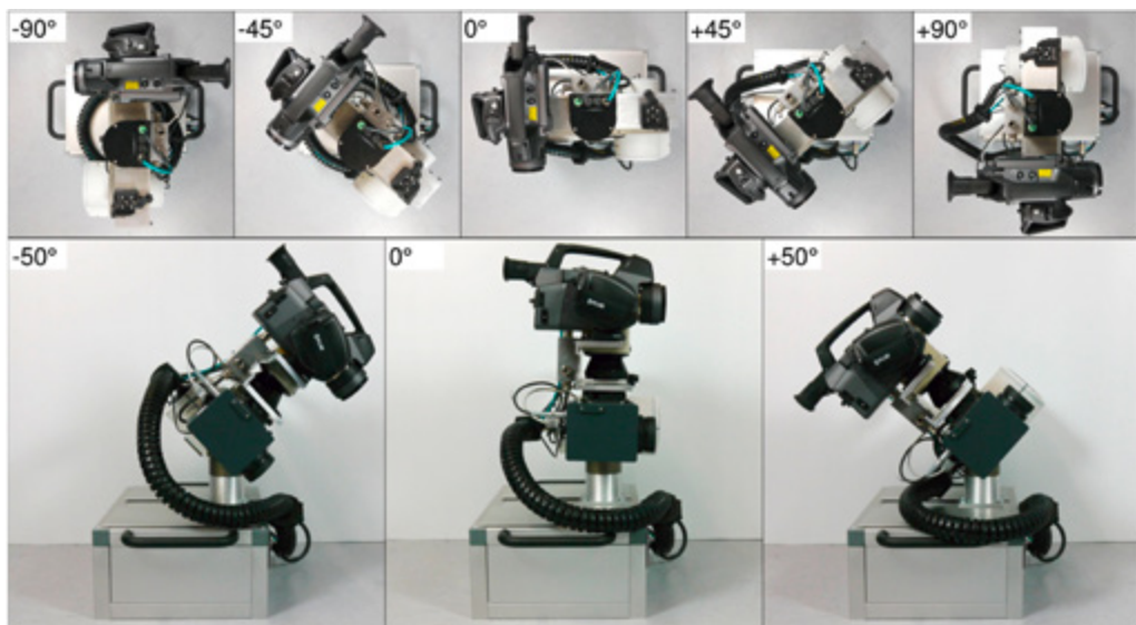
Abb. 2 Schwenkbereich (Draufsicht oben) und Neigebereich (Seitenansicht unten) des Sensorsystems.
