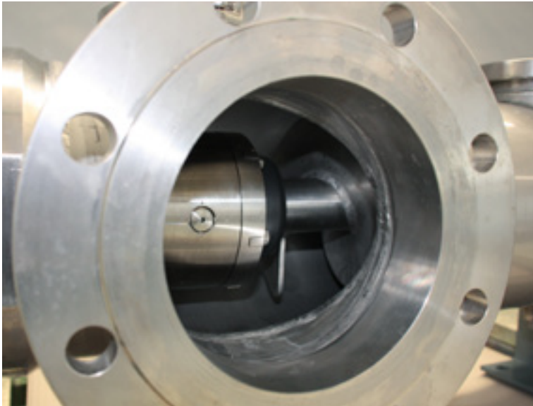
Abb. 2 Diese Bogenzahngelenke verfügen anders als Bolzengelenke über eine doppelte Abdichtung und erhöhen damit die Sicherheit: Wird eine der Gummimanschetten rissig, liegt noch eine zweite darunter, die sofort deren Aufgaben übernimmt
