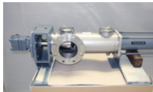
Abb. 1 Über zwei Inspektionsöffnungen lässt sich im laufenden Betrieb kontrollieren, ob die Gelenke noch genügend geschmiert und die Abdichtungen noch intakt sind
