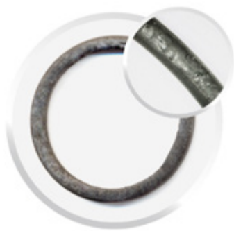
Ein durch Explosive Dekompression beschädigter O-Ring.
