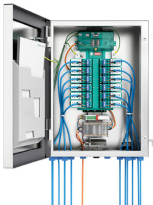
Feldbarriere: Der „Unterverteiler“ für die Zone 1. Feldgeräteanschlüsse sind für alle Geräte beim Feldbus gleich. Die Ausgänge schalten zum Schutz des Segments bei genau identifizierten Fehlern zuverlässig ab.
