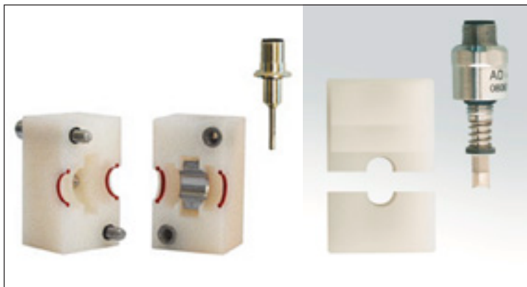
Abb. 1 Ausführungsbeispiele für Geräte zur Rohroberflächenmessung
