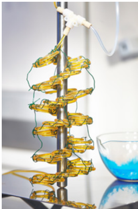
Abb. 1 Herzstück der kontinuierlichen MOF-Herstellung: mikrofluidische Reaktorstrukturen
